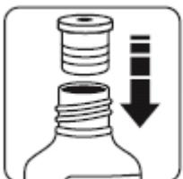
5) O dosador (foguete) não pode conter ar. Para retirá-lo, puxe e empurre o êmbolo, que deve estar vazio. Em seguida, abra a tampa do batoque e encaixe o dosador (foguete) na boca do frasco, conforme indica a Figura 5.
