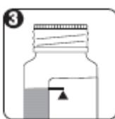
3. Espere a espuma baixar e veja se a suspensão atinge realmente a marca indicada no frasco. Se não atingir exatamente a marca, adicione mais água filtrada (em temperatura ambiente) até chegar ao nível certo.
