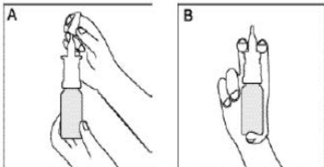
Remova a tampa e pressione a válvula 2 vezes até notar uma fina névoa sendo liberada; isso serve para promover o enchimento interno da válvula e proporcionar a dose exata no momento da aplicação, conforme demonstrado nas figuras A e B.
